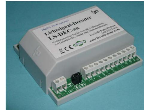
Der **Lichtsignal-Decoder LS-DEC-BR** kann bis zu **vier British Railway Lichtsignale** über **Zubehöradressen digital** stellen.
