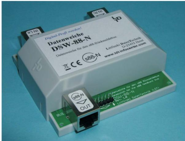
Beim s88-Rückmeldebus müssen alle Rückmelde module hintereinander verlegt werden. Mit der **Datenweiche DSW-88-N** haben Sie die Möglichkeit, den **s88-Rückmeldebus** zu verzweigen.
