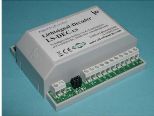
Mit dem Lichtsignal-Decoder LS-DEC-KS ist es möglich, Ks-Lichtsignalbilder über **Zubehöradressen** zu stellen. Pro Lichtsignal-Decoder LS-DEC-KS können zwei Ks-Signale des Ks-Signalsystems der Deutschen Bundesbahn digital gestellt werden. Es können Ks-Einfahr-, Ks-Ausfahr-, Ks-Vorsignale sowie Ks-Einfahr- und Ks-Ausfahr-Mehrabschnittssignale mit bis zu 16 Signalbegriffen angeschlossen und angesteuert werden. Die Leuchtdioden (LED's) der Signale **blinken** bei den entsprechenden
